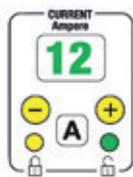
Rilevare il valore della corrente in ampere dalla targa del motore della pompa. Premere il pulsante **A** [led verde acceso] e impostare il valore sul display con i pulsanti **+** e **-** (passo 0,5 A).
