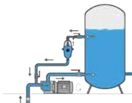
All'avviamento della pompa, si crea una depressione che genera un flusso d'acqua dal serbatoio verso l'aspirazione della pompa passando attraverso il venturi dell'alimentatore e generando un flusso d'aria dall'esterno che progressivamente si sostituisce all'acqua contenuta nell'alimentatore.
