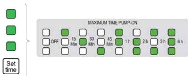
Tenere premuto il tasto "Set Time" per impostare il tempo massimo di pompa on. A ciascuna combinazione di LED corrisponde il tempo massimo di pompa on indicato in tabella. Superato il tempo di funzionamento in continuo l'apparecchio arresta la pompa e si accende la luce rossa Failure. Per ripristinare il normale funzionamento premere il tasto "Restart".
