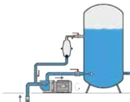
Durante il funzionamento della pompa, il livello dell'acqua all'interno dell'alimentatore cala finché il galleggiante non arriva a chiuderne l'uscita. L'alimentatore a questo punto è pieno di aria.
