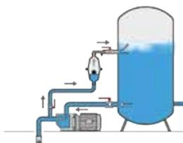
All'arresto della pompa si genera un flusso di acqua che dal serbatoio attraversa la pompa e riempie l'alimentatore spingendo l'aria in esso contenuta all'interno del serbatoio. L'alimentatore è pronto ad eseguire il ciclo successivo.
